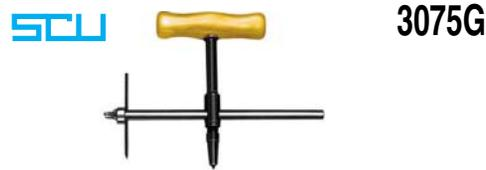
In acciaio, con asta scorrevole regolabile. Per guarnizioni di cuoio, gomma, materie plastiche, sintetiche, ecc. Attacco cilindrico Ø mm 17 per uso su trapani.
